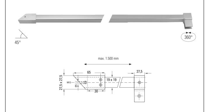
Die Stabilisationsstange ist ohne zusätzliche Glasbearbeitung zu montieren. Das Glasaufnahmeteil des Glasanschlusses ist 360° drehbar.
